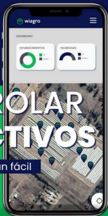
Observa en forma rápida y en tiempo real la información de parámetros de conservación generales como: temperatura, humedad inter-granaria y dióxido de carbono, a través de una plataforma web/mobile.
